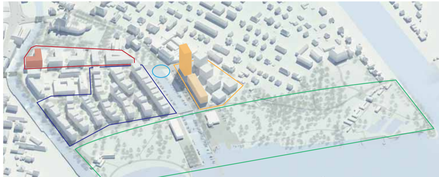
ZPP 7.5 Verdichtete Wohnüberbauung mit gemischter Nutzung (Wohnen, Dienstleistungen, Cafés) - erste 20 m entlang Uferweg bis maximal 7-geschossige Bauten Rest 4 bis max. 8 Geschosse - Gebäudelänge vereinzelt bis 150 m ZPP 7.3 Hochhaus mit bis zu 70 m Höhe Längsgebäude (bspw. Hotel) bis max. 7 Geschosse. Rest bis max. 10 Geschosse. In diesem Bereich wird ein Projektwettbewerb veranstaltet. Auf Basis des Siegerprojekts wird eine neue Überbauungsordnung ausgearbeitet, über die Bevölkerung abstimmen kann. Erst dort werden die Details der Baumöglichkeiten definiert. Möglicher, aber nicht definitiv beschlossener Standort für eine zentrale Tiefgarage ZPP 7.1 Gebäude Rgt. Bahnhof (Zühlbrücke) als Akzent bis max. 9 Geschosse. - 30 m entlang der Dr. Schneider-Strasse bis zu 6 Geschosse Rest (Rtg. Schloss) maximal 4 Geschosse. Grüngürtel: Erholungs- und Uferschutzzone; im Bereich Barkenhafen besteht die Möglichkeit für einen Ersatzbau des Lago Lodge
